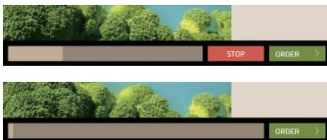
1. Si "Actif" est sélectionné, la préparation de la boisson peut être interrompue en appuyant sur "Stop".
