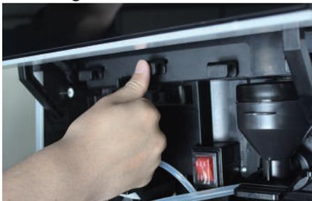
7. Insérer à fond la languette de verrouillage.
