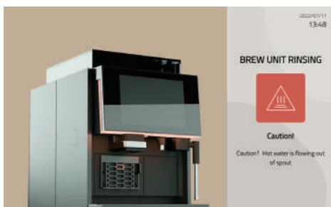
2. Le rinçage peut également être lancé manuellement. Appelez le menu Maintenance > Rinçage et appuyez sur l'option de rinçage souhaitée pour lancer immédiatement le rinçage.
