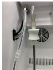
3. Connecter tuyau pour le lait (entrée) au tuyau de lait.
