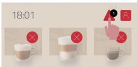
En cas d'erreur, l'appareil affiche un message d'erreur, indiqué par un triangle rouge dans le coin supérieur droit du panneau de commande. Tapez sur ce symbole pour obtenir de plus amples informations.
