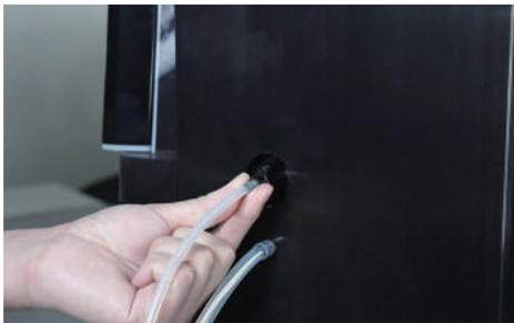
1. Raccorder le tuyau à lait à la machine.
